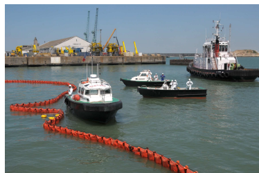
Mise en place d'un barrage anti-pollution.
