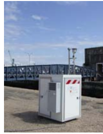
Site n° 2 : près de l'écluse, la surveillance des poussières et des oxydes d'azote a permis de localiser les sources d'émission.
