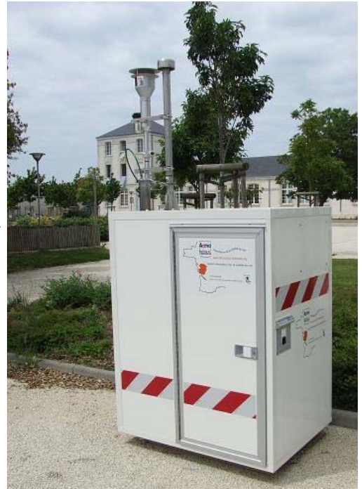
À La Pallice (site n°4), ATMO a quantifié l'influence du port, par comparaison des résultats de mesures lorsque le site était exposé au port et lorsqu'il ne l'était pas.
