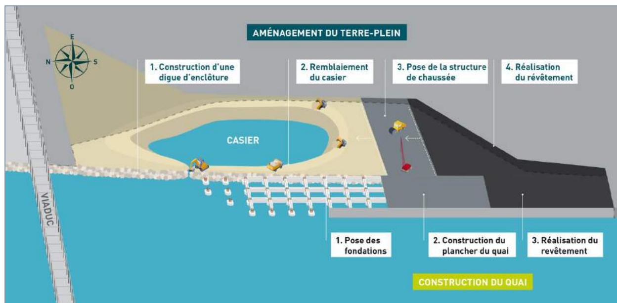
Figure 7 : Principe d'aménagement de l'Anse Saint-Marc 3 (source PALR)
