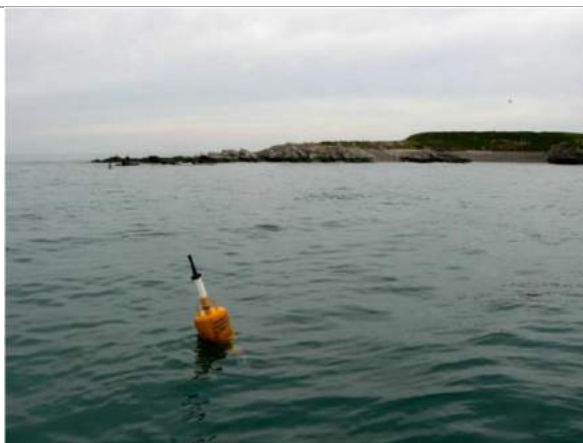
Figure 5 : Exemple d'une bouée de suivi de la turbidité (source NKE)
