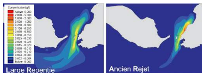
Figure 12 : Simulation du panache du rejet montrant le moindre impact d'un rejet au large de la Repentie par rapport à la situation de 2013. Source dossier.
