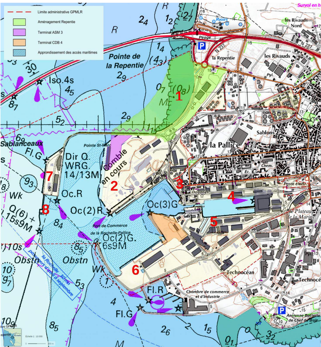
Figure 2 : Carte du site du port de La Rochelle à l'échelle 1/10 000. Les nombres figurés en rouge correspondent aux différents terminaux (1 : La Repentie ; 2 : anse Saint-Marc ; 3 : Port de service ; 4 : bassin à flot ; 5 : pôle de réparation et de construction navale ; 6 : Chef de Baie ; 7 : môle d'escale ; 8 : terminal pétrolier. Les zones de travaux sont figurées en couleur selon le cartouche en haut à gauche. Sources IGN, Shom et dossier.
