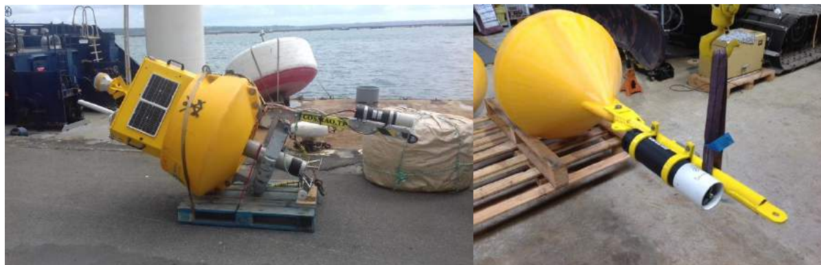
Figure 1 : Vue des bouées de suivi de turbidité de Brest et de Monaco (source Gaïa Terre bleue)
