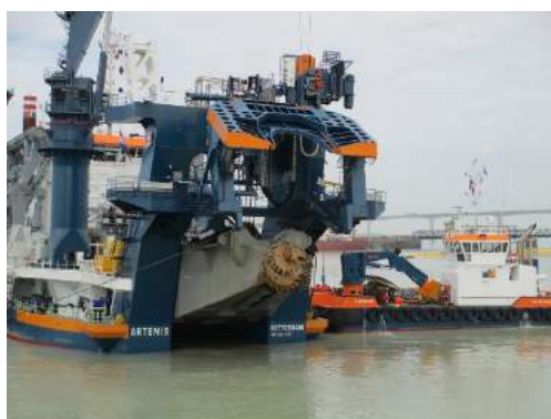
Figure 7 : Déroctreuse hydraulique avec vrille foreuse aspiratrice. Source dossier.
