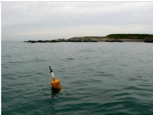
Figure 10 : Exemple d'une bouée de suivi de la turbidité (source NKE)
