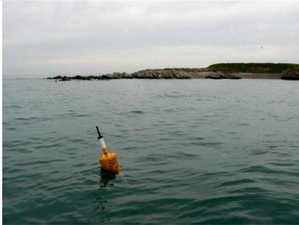
Figure 6 : Exemple d'une bouée de suivi de la turbidité (source NKE)
