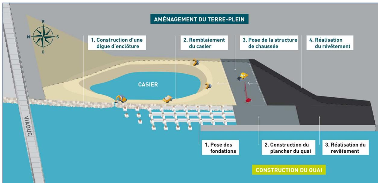
Figure 7 : Principe d'aménagement de l'Anse Saint-Marc 3 (source PALR)
