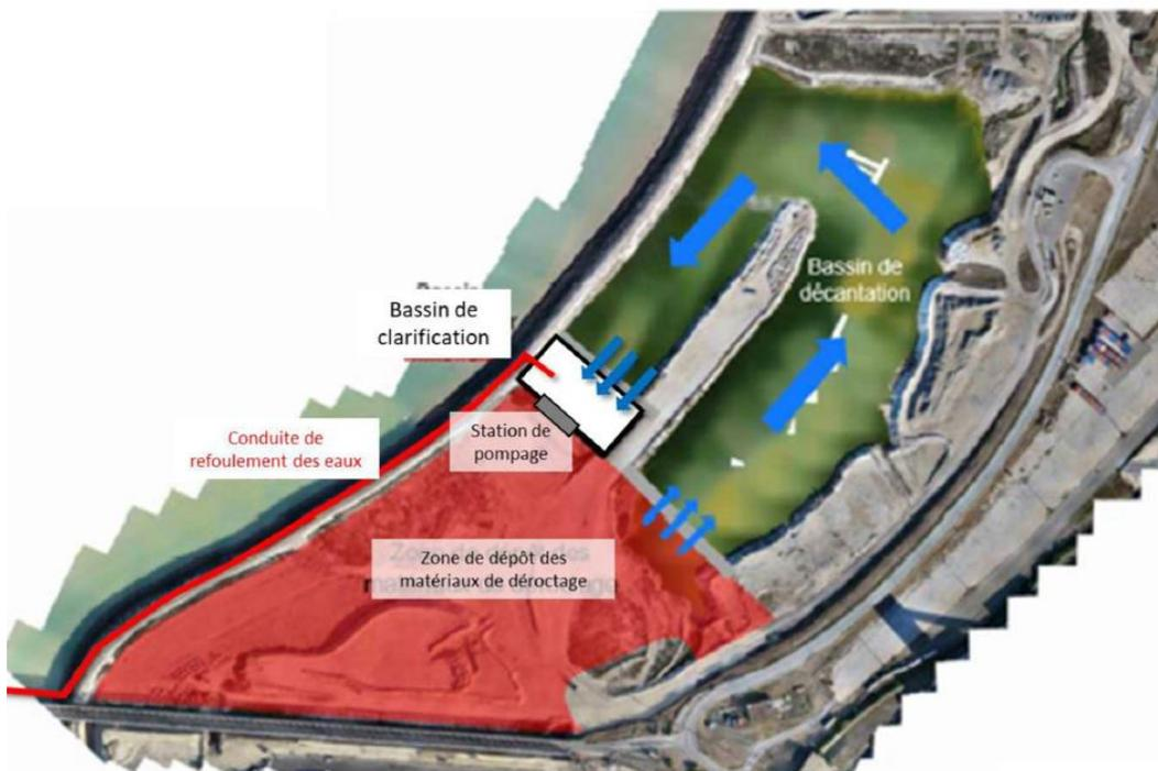
Figure 14: Organisation schématisée de la zone de la Repentie pour le refoulement hydraulique des matériaux et la gestion des eaux de ressuyages
