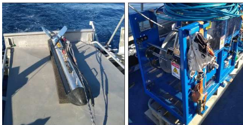
Figure 35 : Sonar EDGETECH 4200 MP (à gauche), son treuil de remorquage (à droite)
