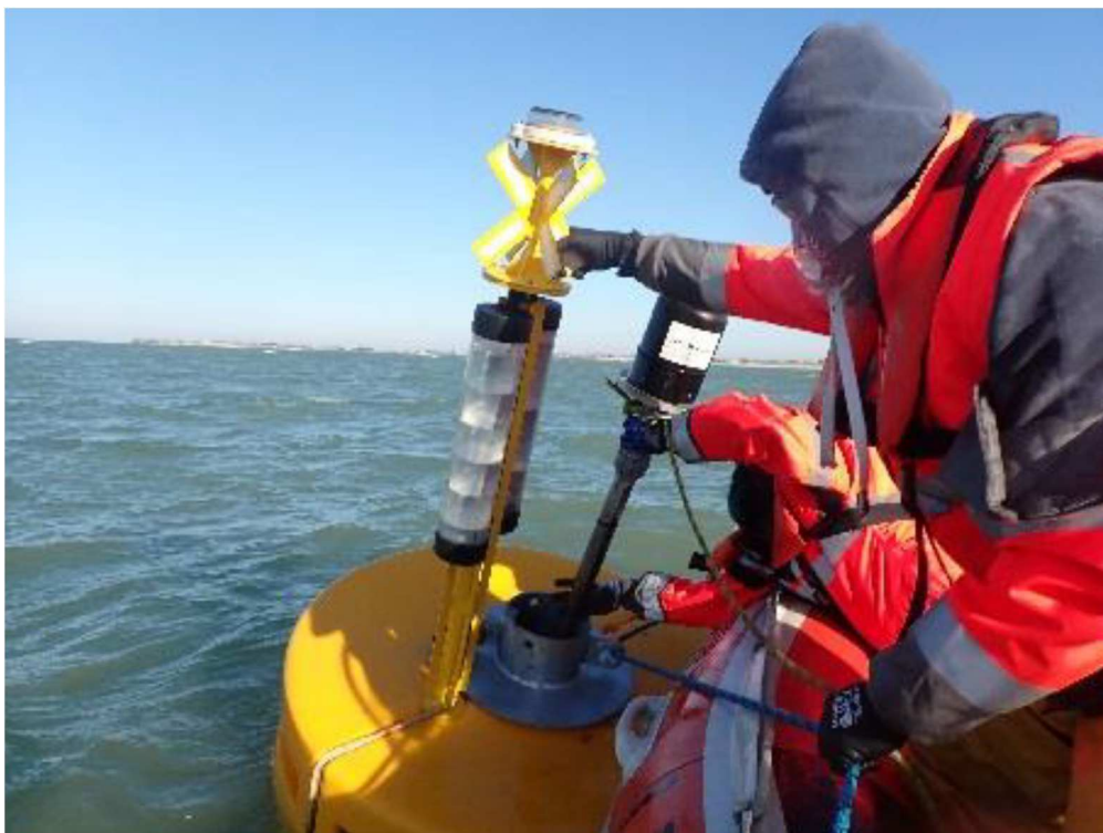
Figure 23 : Récupération de la perche centrale supportant les capteurs de la bouée de Suivi 2 pour nettoyage et entretien (Créocœan, novembre 2020)
